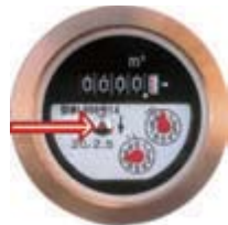
ここが回っていると宅内漏水しています。
