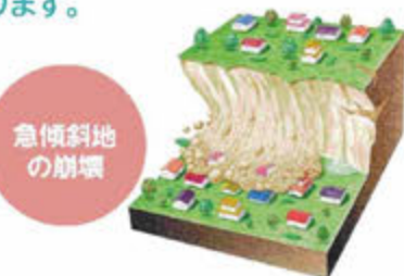
急な斜面（がけ）が突然崩れ落ちる現象です。大雨や地震が引き金になって起こります。
