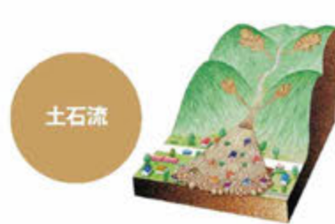
大雨などで山の斜面が崩れたり谷底にたまった土砂が流れ出したりしたときに水と土砂が混じりあってもすごい勢いで谷から流れ出す現象です。
